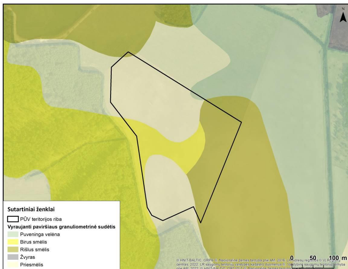
9 pav. Vyraujanti paviršiaus granulimetrinė sudėtis
