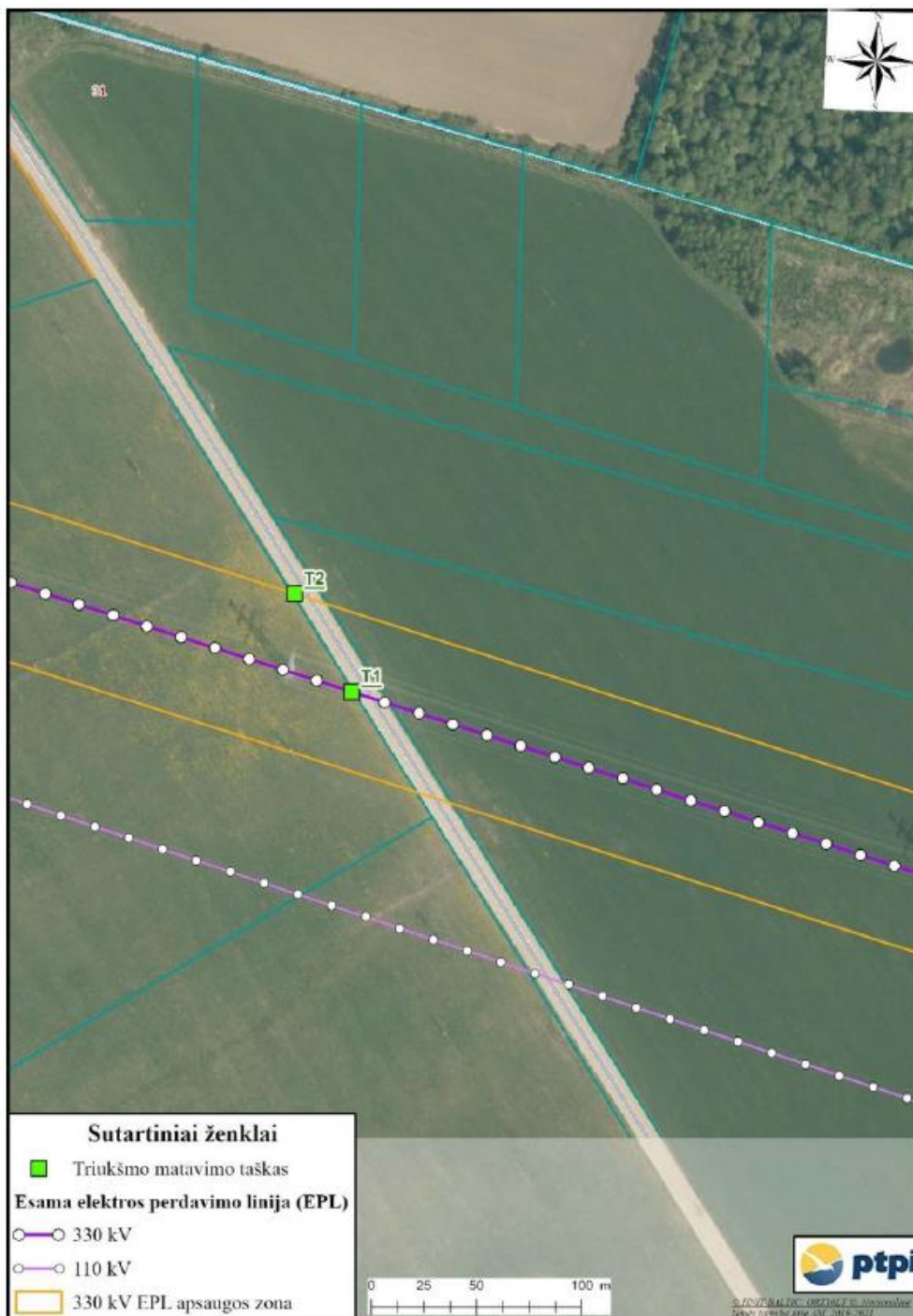
39 pav. Esamos 330 kV dvigrandė EPL triukšmo matavimo taškai 16
