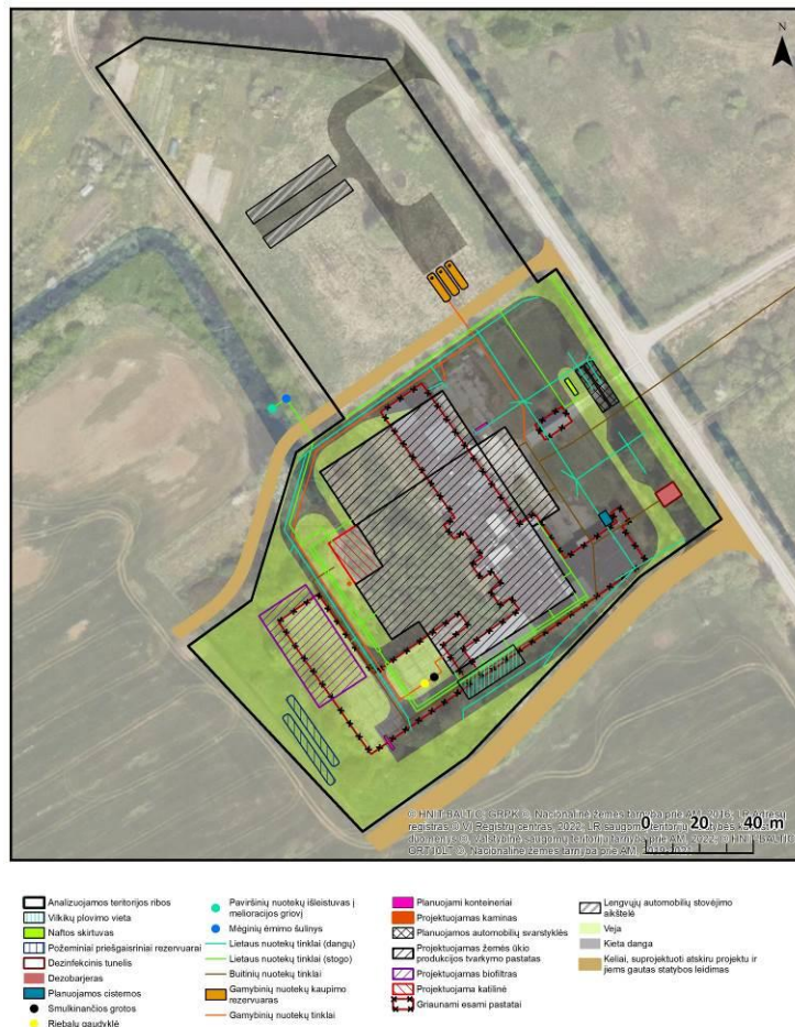
9 pav. Principinė schema. Nuotekų tvarkymo inžinerinė infrastruktūra
